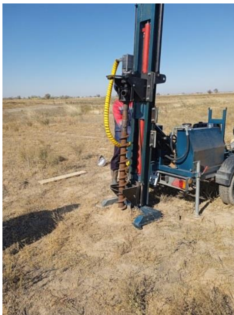
Рисунок 1- Контрольное бурение для определения естественной влажности почвы и наличия грунтовых вод
