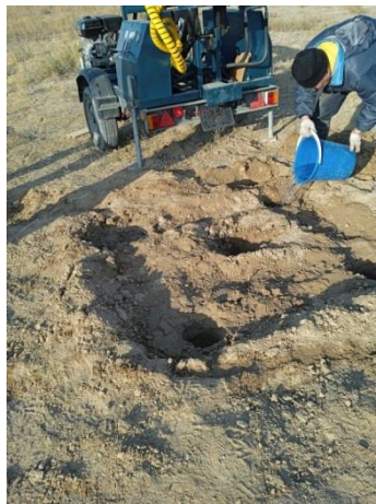
Рисунок 6 - Заполнение опытных скважин раствором
